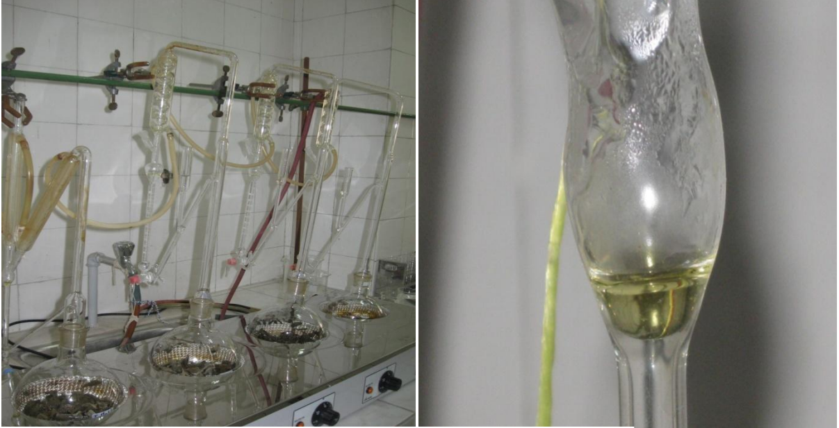
Şekil 3.20. Uçucu yağ çıkarma ünitesi ve elde edilen uçucu yağ
