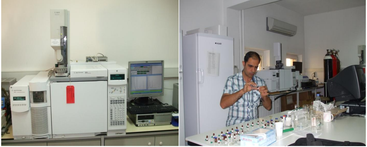
Şekil 3.21. Uçucu yağların analize hazırlanması ve analizde kullanılan GC/MS
