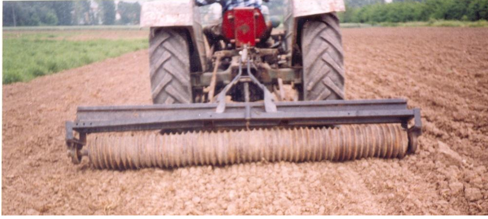
Şekil 3.15. G1+BA+Merdane uygulamasında kullanılan merdane
