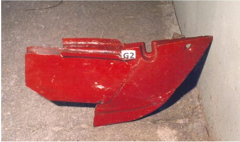
Şekil 3.4. G2 olarak adlandırılan çizi açıcı ayak
