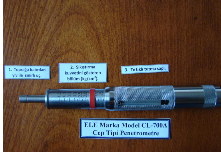
Şekil 3.17. Mekanik cep tipi Penetrografın şematik görünümü
