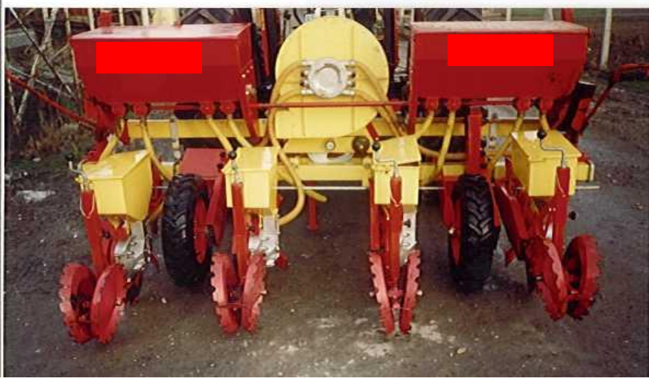
Şekil 3.8. BB Baskı tekerinin deneme ekim makinesine takılmış durumda görünüşü
