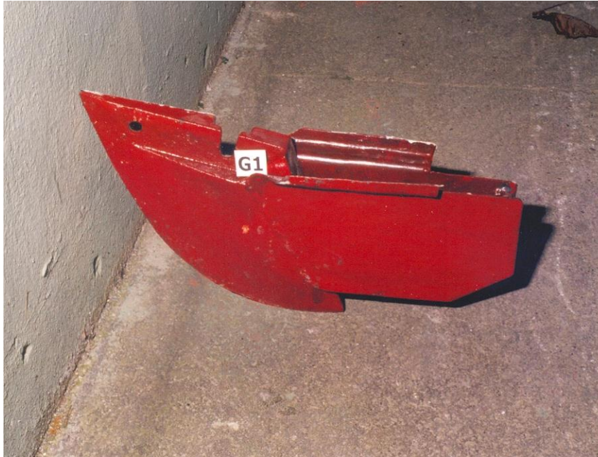
Şekil 3.2. G1 olarak adlandırılan çizi açıcı ayak
