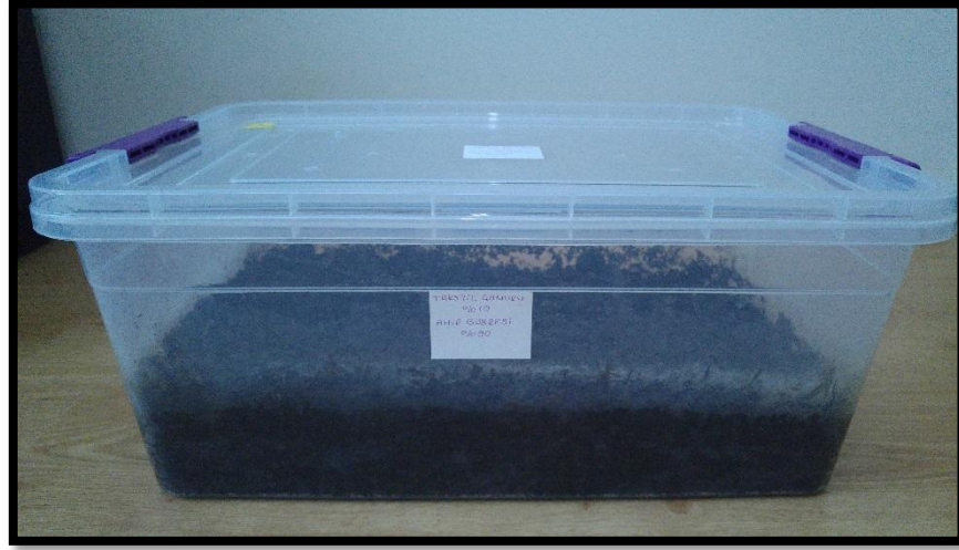
Şekil 3.2: Eysel ve Endüstriyel Arıtma Çamuru Kompost Kapları
