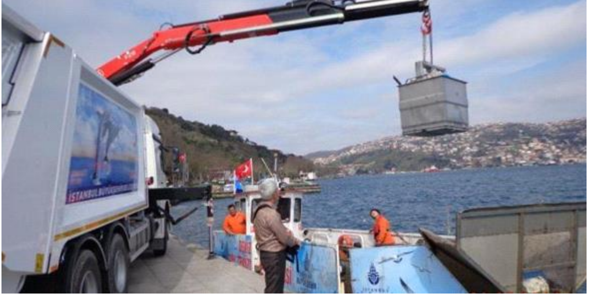
Resim 2.11 Vinçli sıkıştırılmalı atık toplama aracı (İSTAÇ 2016)
