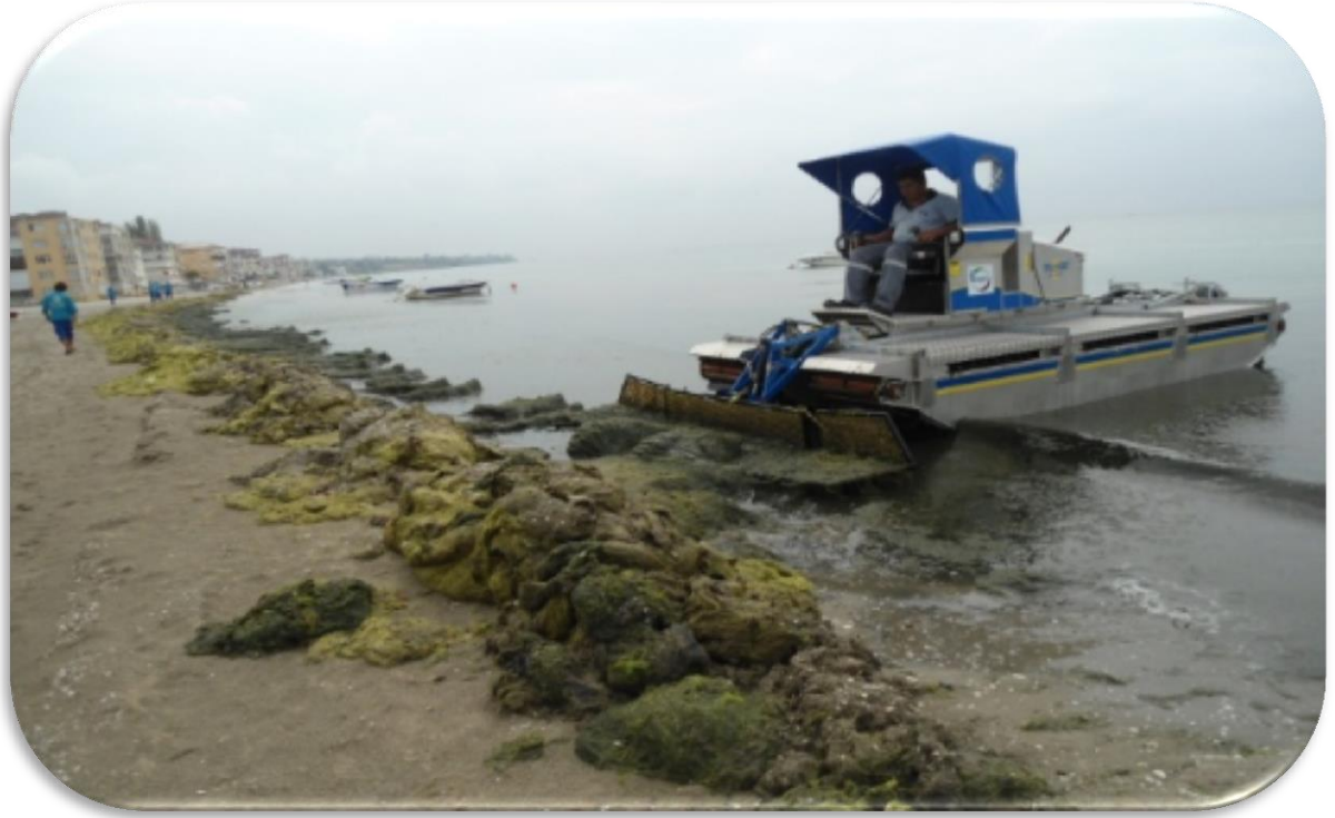
Resim 2.32. Yosun temizleme aracı ile yosun temizliđi (İSTAÇ 2016)
