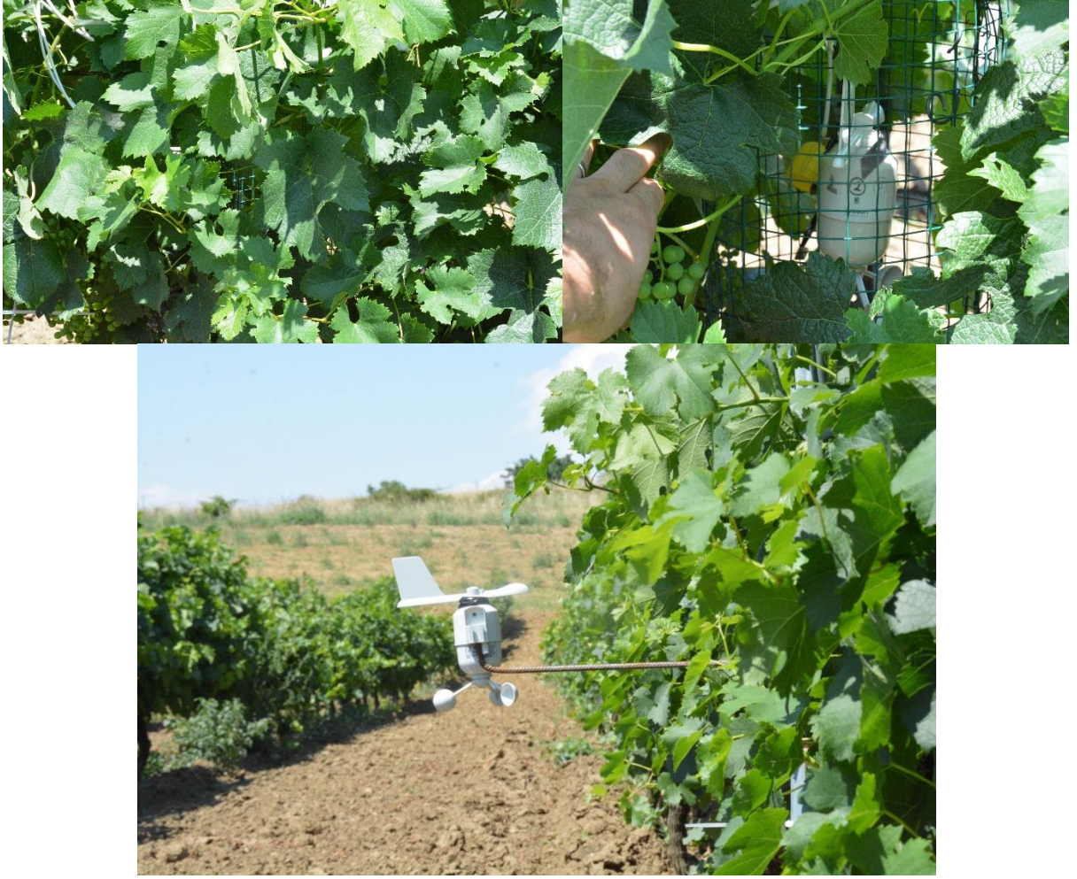
Şekil 3.4. Rüzgar hızı duyarlarının yerleşimleri (S. Candar 2015 orijinal fotoğraf)
