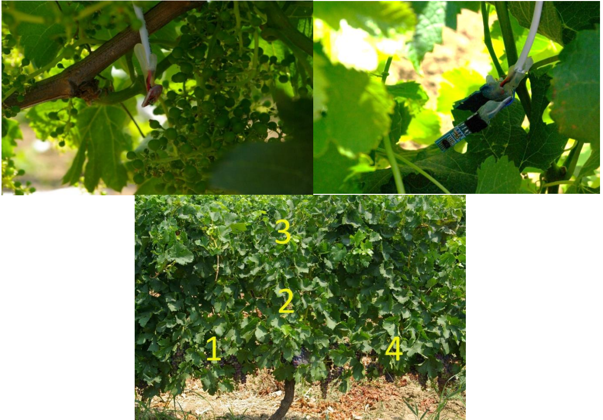
Şekil 3.3. Duyargaların taç içi yerleşimleri (S. Candar 2015 orijinal fotoğraf)
