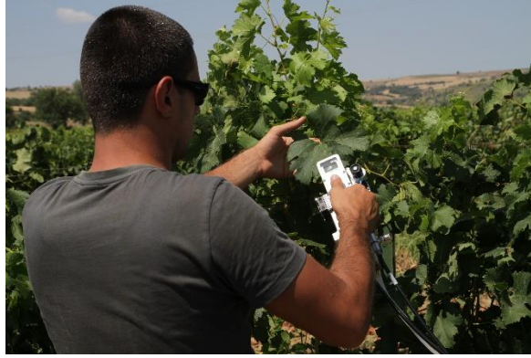
Şekil 3.7. Fotosentez (A) miktarı, transpirasyon (E) oranı ve stoma iletkenliđi ( g_s ) ölçümlerinden görüntüler (S. Candar 2015 orijinal fotoğraf)
