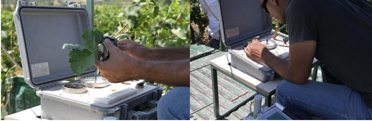
Şekil 3.8. Yaprak su potansiyeli ölçümlerinden görüntüler (S. Candar 2015 orijinal fotoğraf)
