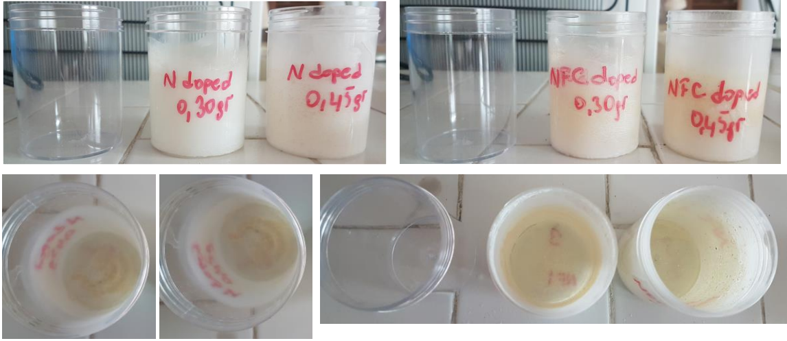
Resim 4.3.3.2. Sıvanmamış PS kap ve immobilize edilen PS/Cup-N/0,3g ve PS/Cup-N/0,45g fotokatalistlerin görüntüsü
