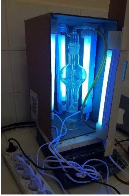
Şekil 4.4.1. Toz formdaki N-doplu ve NFC-doplu TiO 2 fotokatalistlerle IOP Deney Düzenegi
