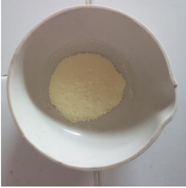
Resim 4.3.2. Hazırlanan toz formda NFC-doplu TiO 2
