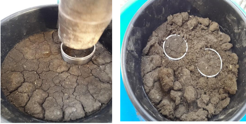
Şekil 3. 4. Saksılardan bozulmamış toprak örneği alınması
