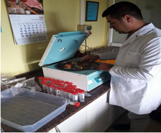
Şekil 3.2. KDK analizinde toprak örneklerinin santrifüj edilmesi
