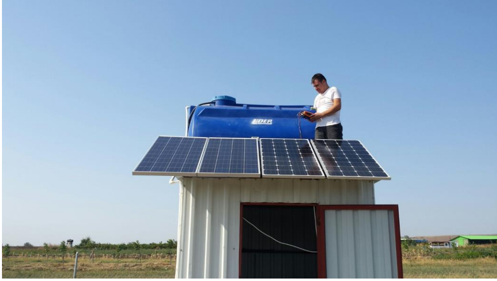
Şekil 3. 4. 20° panel eğim açısında yapılan ölçüm görüntüsü
