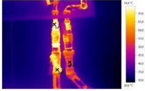
Şekil 4. 4. Termal kamera görüntüsü-kombi su giriş çıkış hattı
