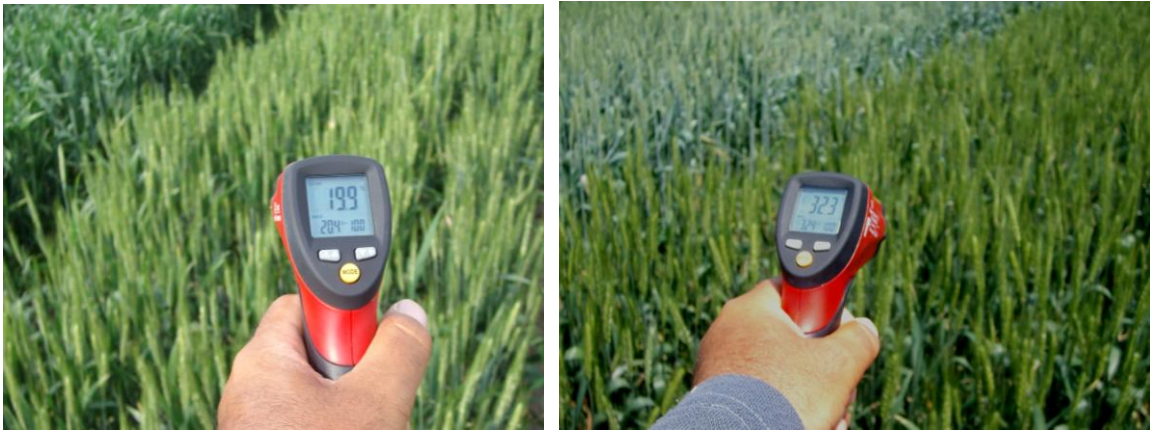
Şekil 4.40. Araştırmada yer alan genotiplerde infrared termometre ile bitki örtüsü sıcaklığının ölçüm işlemi
