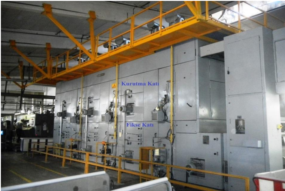
Şekil 5.4 Yünsa işletmesindeki katlı ramöz makinesinin görünümü
