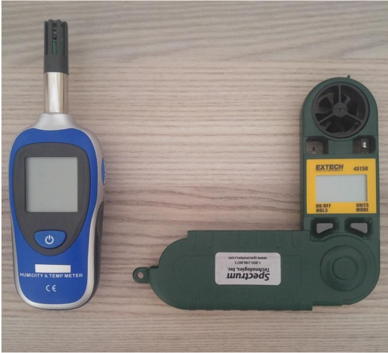
Şekil 3.3. Mini Humidity&Temp. Meter (LYK 903) (solda) ve Spectrum 45158 (sağda) (Rüzgâr, nem, sıcaklık ölçer)
