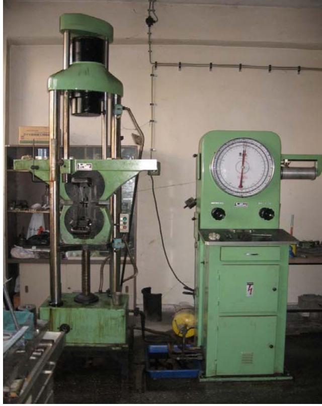
Şekil 7. Çekme Deneyi Cihazı (T.Ü. Mak. Müh. Malzeme Laboratuvarı)
