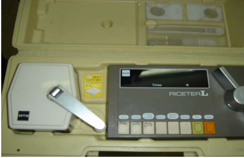
Şekil 3.2. Tahılların nemlerinin saptanmasında kullanılan cihazlar
