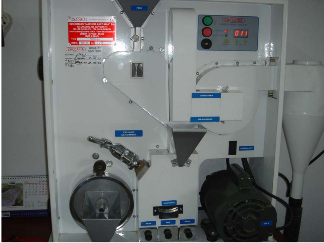
Şekil 3.3. Çeltiğin toplam kırıksız pirinç randımının saptanmasında kullanılan kompakt ekipman
