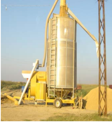
Şekil 3.1. Denemelerde kullanılan farklı kapasitelerdeki depo tipi kurutma sistemleri (1-Makine 1, 2- Makine 2, 3- Makine 3, 4-Makine 4)
