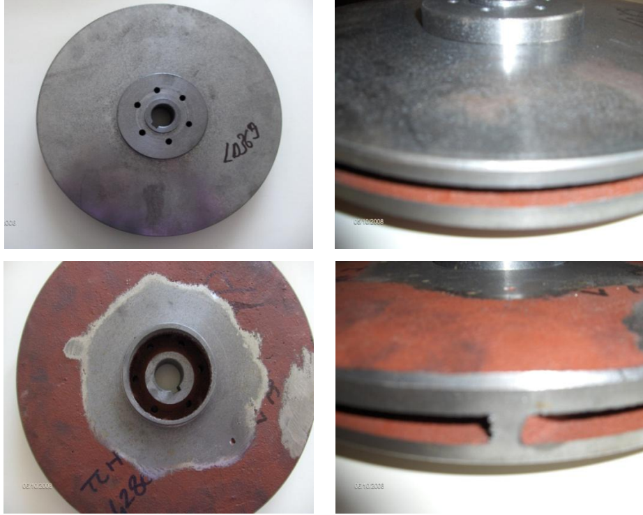
Şekil 4.4. İkinci 200 saatlik sürede denemesi yapılmış çarkın denemeden önceki makro yapı görüntüleri
