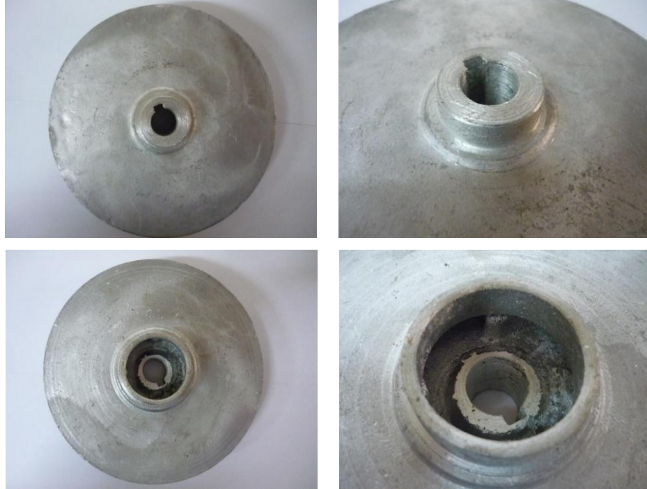
Şekil 4.8. 180 saatlik sürede denemesi yapılmış ikinci alüminyum çarkın denemeden önceki makro yapı görüntüleri
