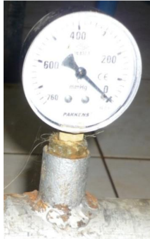
Şekil 3.7. Denemede kullanılan vakummetre
