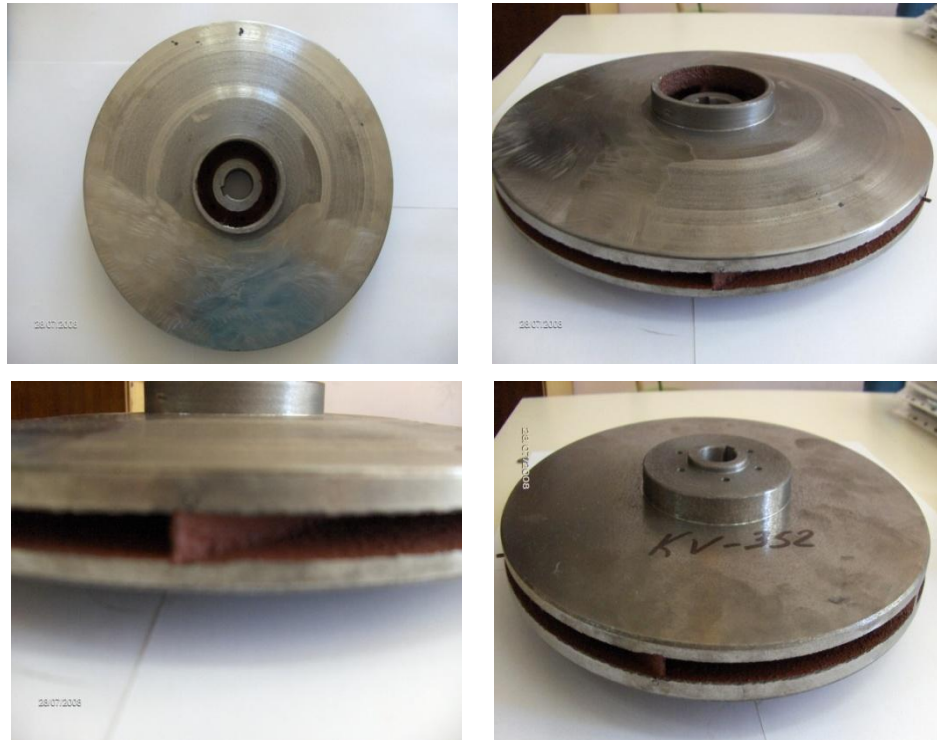
Şekil 4.3. İlk 200 saatlik sürede denemesi yapılmış çarkın denemeden önceki makro yapı görüntüleri
