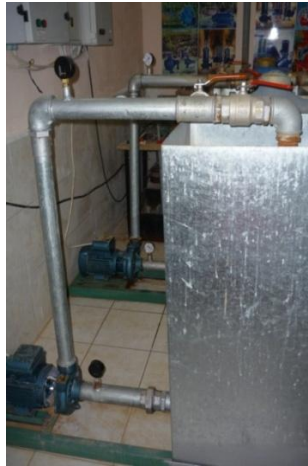
Şekil 3.10. Suyun açık devre sistemde devir daimini sağlayan emme ve basma boruları
