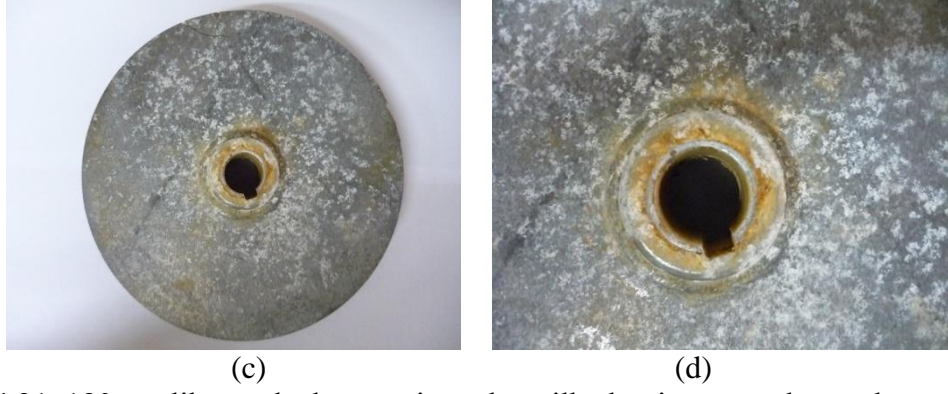
Şekil 4.21. 180 saatlik sürede denemesi yapılmış ilk alüminyum çarkın makro yapı görüntüleri
