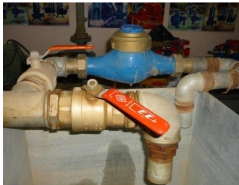
Şekil 3.8. Denemede debi ölçümünde kullanılan su sayacı
