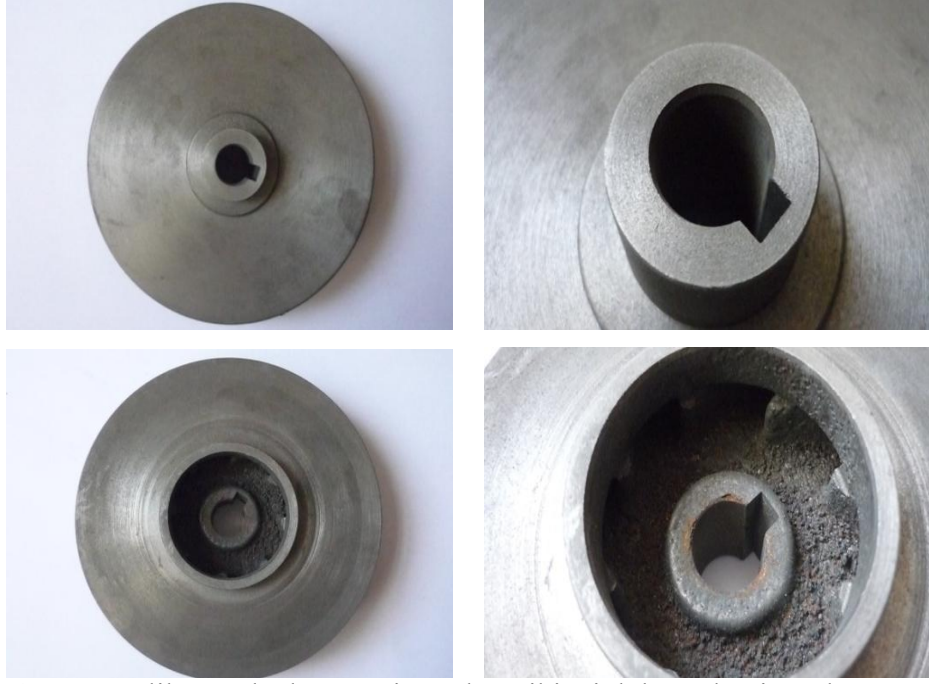
Şekil 4.6. 180 saatlik sürede denemesi yapılmış ikinci dökme demir çarkın denemeden önceki makro yapı görüntüleri
