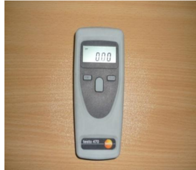
Şekil 3.12. Denemede kullanılan devir ölçüm cihazı
