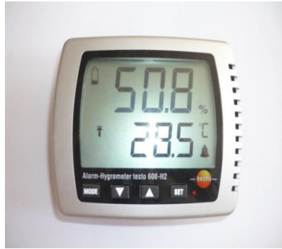
Şekil 3.14. Denemede kullanılan termohigrometre
