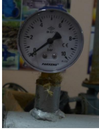
Şekil 3.6. Denemede kullanılan manometre
