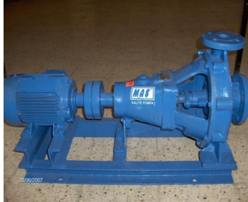
Şekil 3.1. Denemede kullanılan santrifüj pompa
