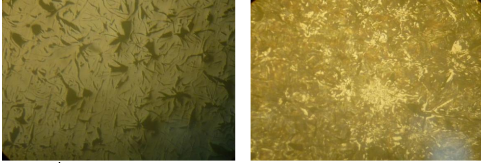
Şekil 4.9. İlk denemeye ait denemesi yapılmamış dökme demir çark malzemesinin mikro yapı görüntüleri
