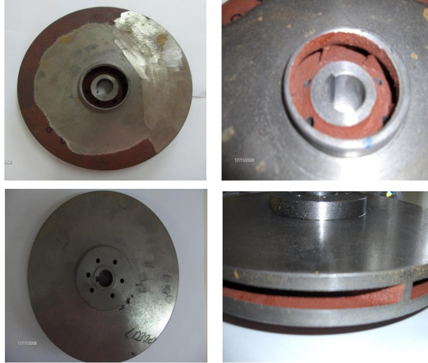
Şekil 4.1. İlk 150 saatlik sürede denemesi yapılmış çarkın denemeden önceki makro yapı görüntüleri
