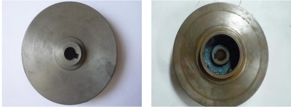
Şekil 4.5. 180 saatlik sürede denemesi yapılmış ilk dökme demir çarkın denemeden önceki makro yapı görüntüleri
