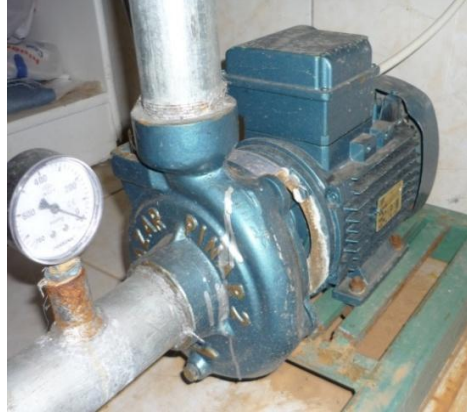
Şekil 3.2. Denemede kullanılan monoblok santrifüj pompa (alüminyum çarklı)
