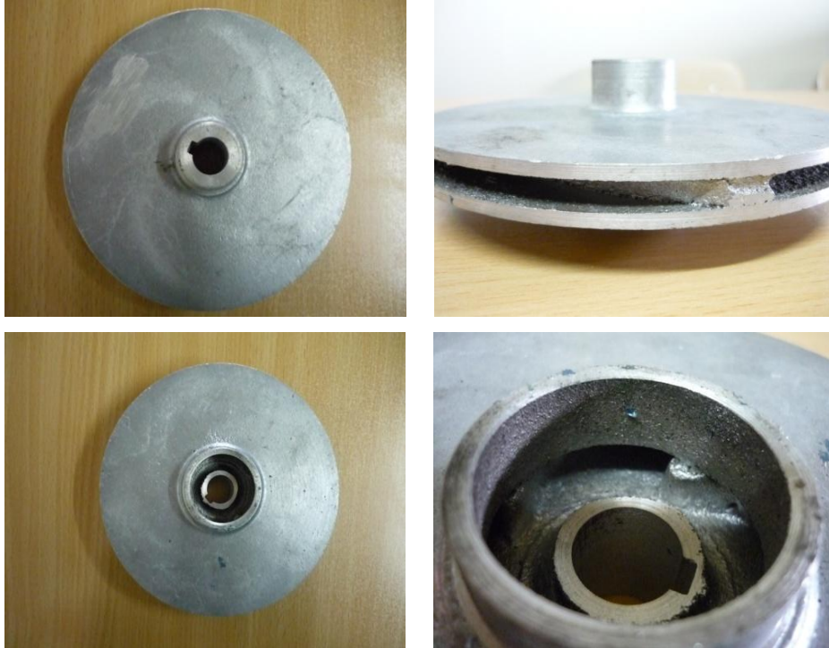
Şekil 4.7. 180 saatlik sürede denemesi yapılmış ilk alüminyum çarkın denemeden önceki makro yapı görüntüleri
