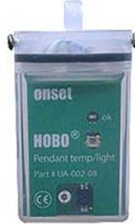
řekil 3.13. Denemelerde kullanılan su geirmez Hobo marka sıcaklık dataloggeri
