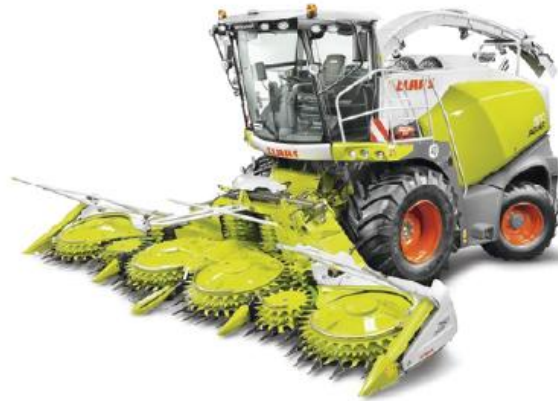
Şekil 3.3. Sıra bağımsız kendi yürür tip silaj makinesi
