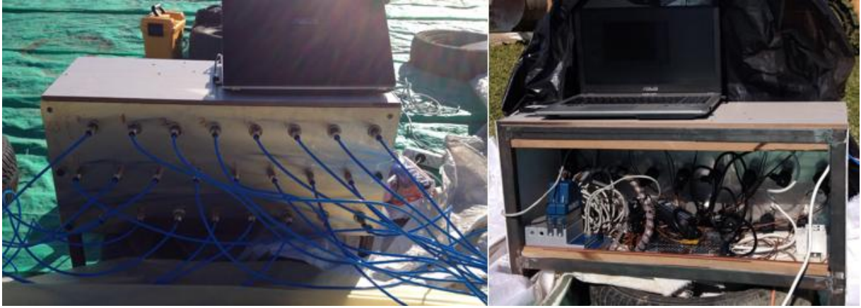
Şekil 3.8. Basınç ölçüm düzeneği ve bağlantı
