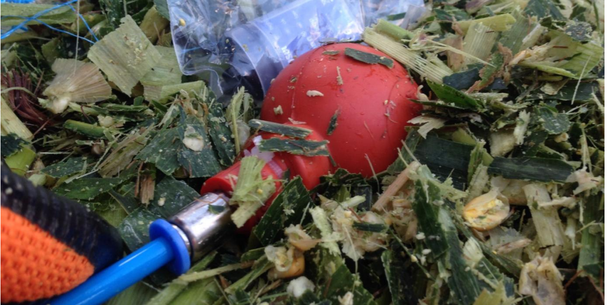
Şekil 3.7. Silaj içi basınçları iletiminde kullanılan kauçuk küre ve hortum bağlantısı
