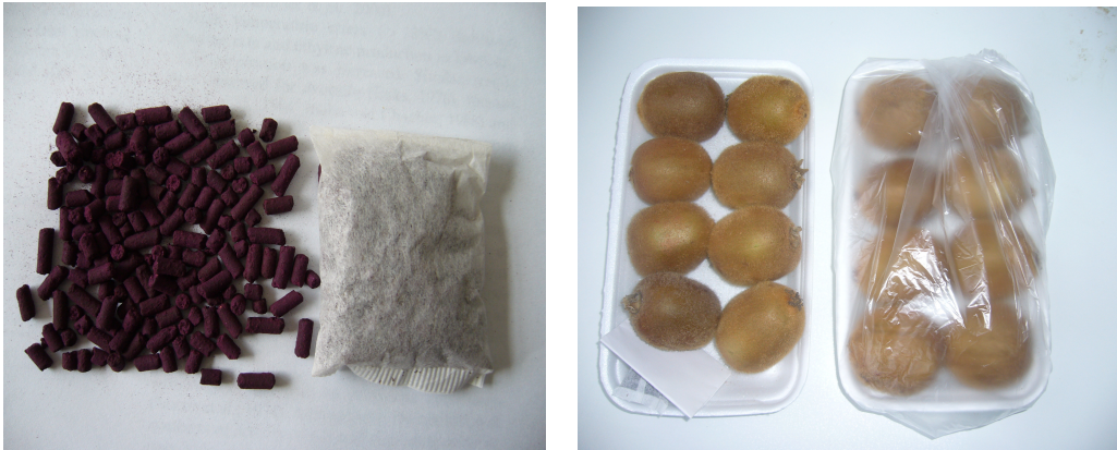
Şekil 3.4. Denemede kullanılan potasyum permanganat granülleri ve paket içerisindeki yerleşimi
