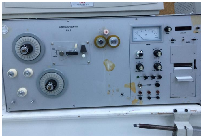
Şekil 6.19. RIC II Interlace Counter cihazı
