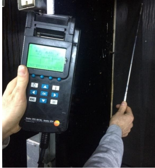
Şekil 6.8. Soğutma hava hızının (m/sn) ölçülmesi
