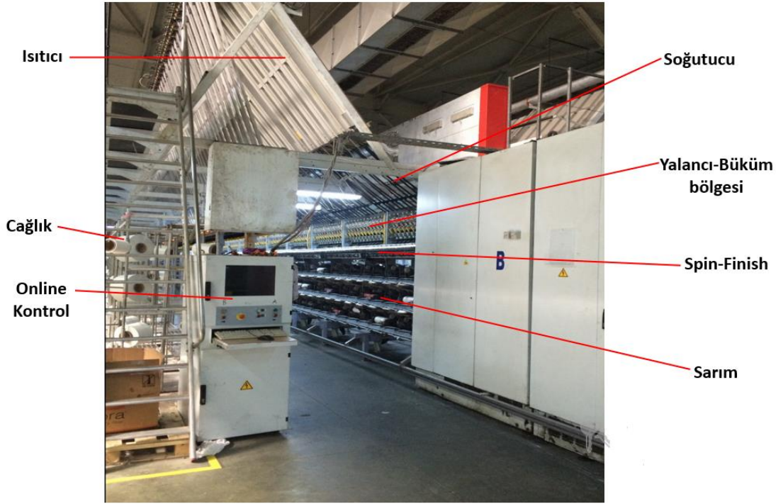
Şekil 3.4. Friksiyon tekstüre makinasına örnek
