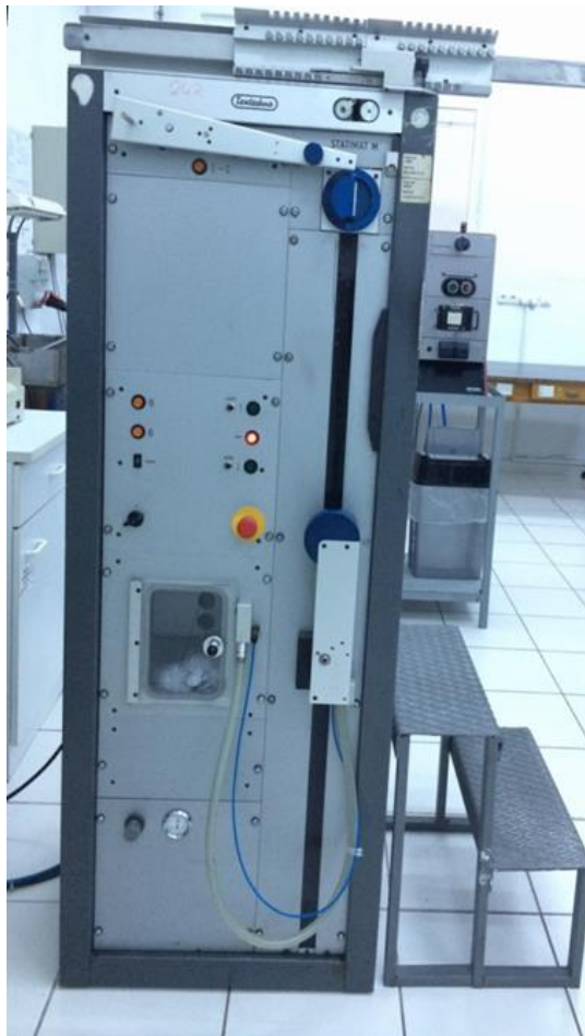
Şekil 6.15. Textechno Statimat M cihazı
