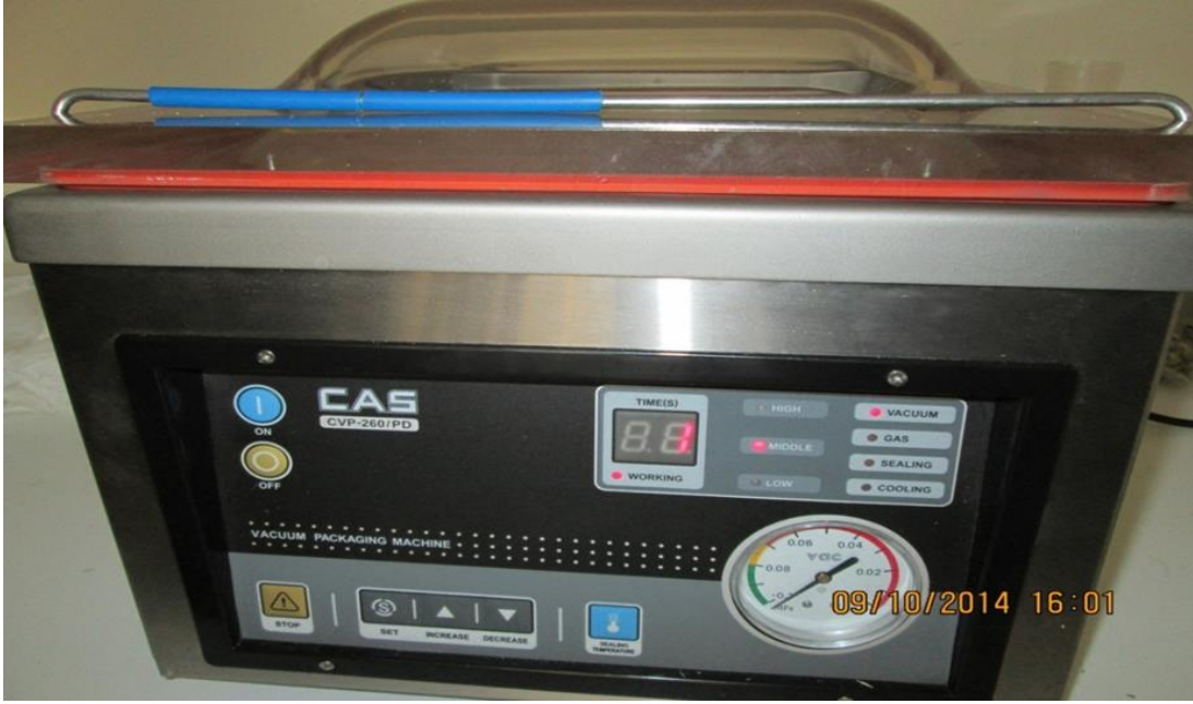
Resim 3.2. Laboratuvar tipi paket silaj makinesi
