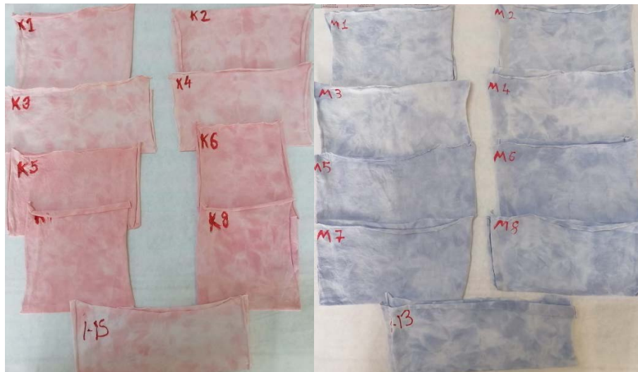
Şekil 4.3. Mavi ve kırmızı renkli termokromik boyalar ile katyonikleştirme sonrası pigment boyama prosesiyle çektirme yöntemine göre yapılan boyamaların sonuçları
