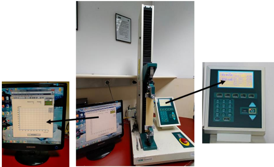
Şekil 2.16. Tinius Olsen - Hounsfield H1KS kopma mukavemeti test cihazı, kontrol ünitesi ve QMAT yazılımı
