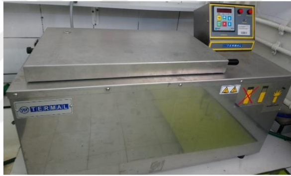
Şekil 2.2. Karışım için kullanılan HT boyama cihazı
