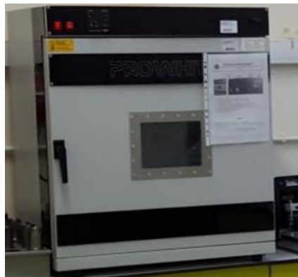
Şekil 2.3. Kurutma işlemi için kullanılan etüv cihazı
