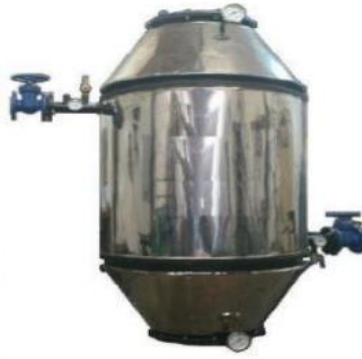
Şekil 2. 24. Helezon ve spiral borulu ekonomizer (Özağdaş, 2020, s. 15).
