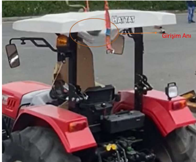
Şekil 3.1. OECD kod 10 testinde çelik güllenin SMC-R25 malzemesi ile çarpışma anı
