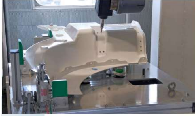
Şekil 2.7. SMC CNC Delik delme operasyonu [15]
