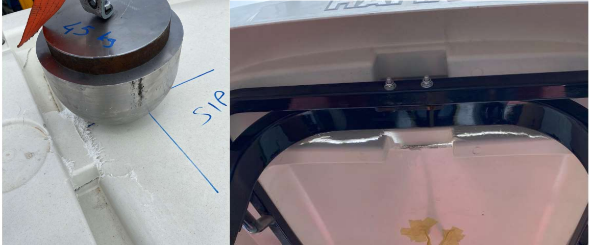
Şekil 3.2. OECD kod 10 testinde, SMC-R25 malzemesine sahip FOPS'ta oluşan deformasyonlar
