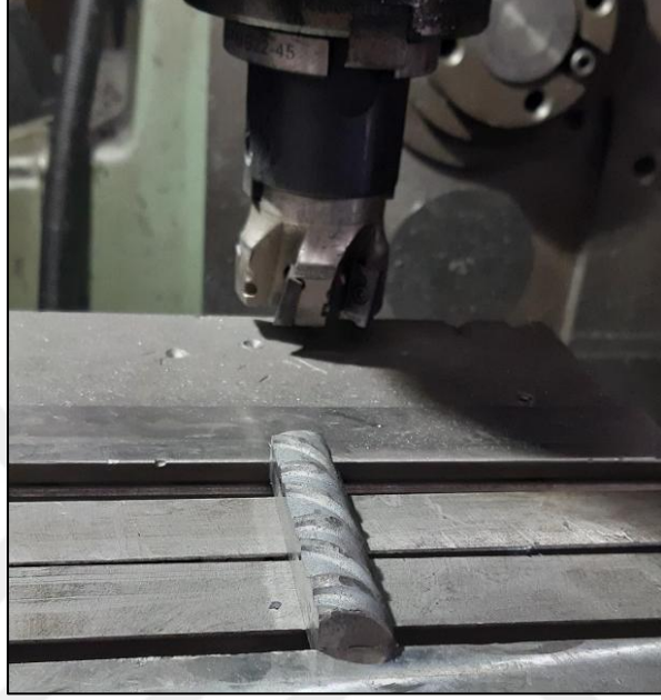
Şekil 3.28. Nervürlü inşaat demirinin CNC freze tezgahında numune haline getirilmesi
