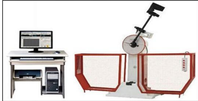
Şekil 1.11. PLC kontrollü darbe test düzeneği
