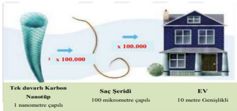
Şekil 2.3. Büyük ölçekli nesnelere nano malzeme boyut karşılaştırmasının gösterimi (Raufi, 2018)
