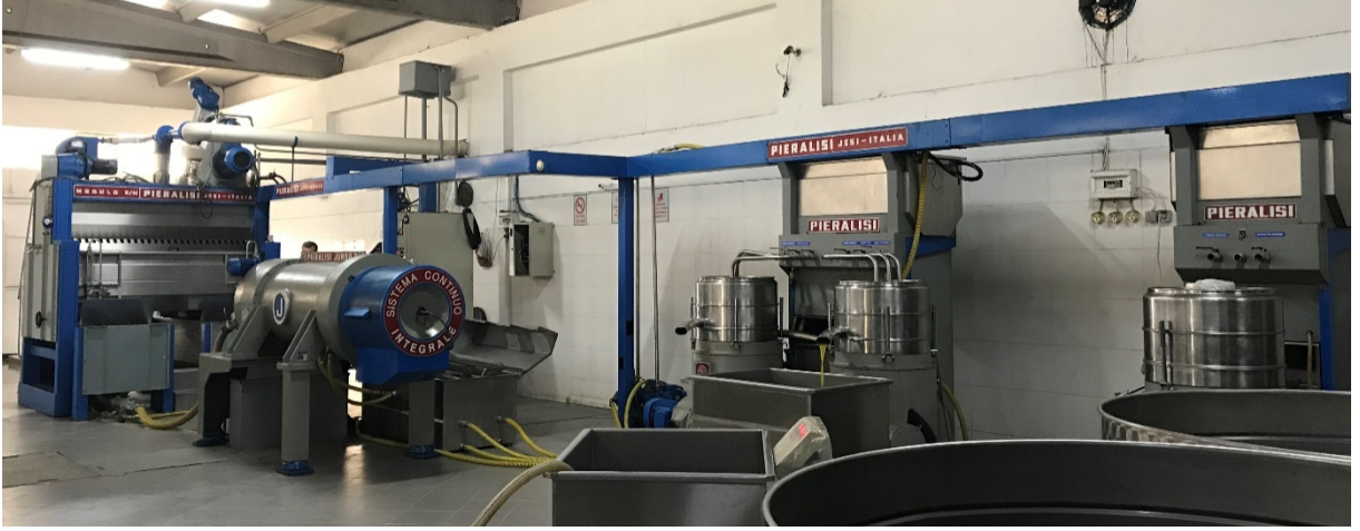
Şekil 2.4. Kontinü sistem zeytinyağı sıkım prosesi
