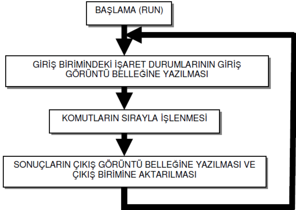
Şekil 3.5. PLC işlem basamakları [25]
