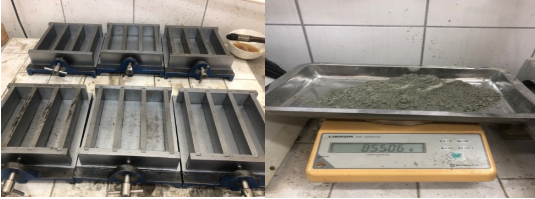
Şekil 3.5. Harç numune kalıpları (a) ve hassas terazi (b)
