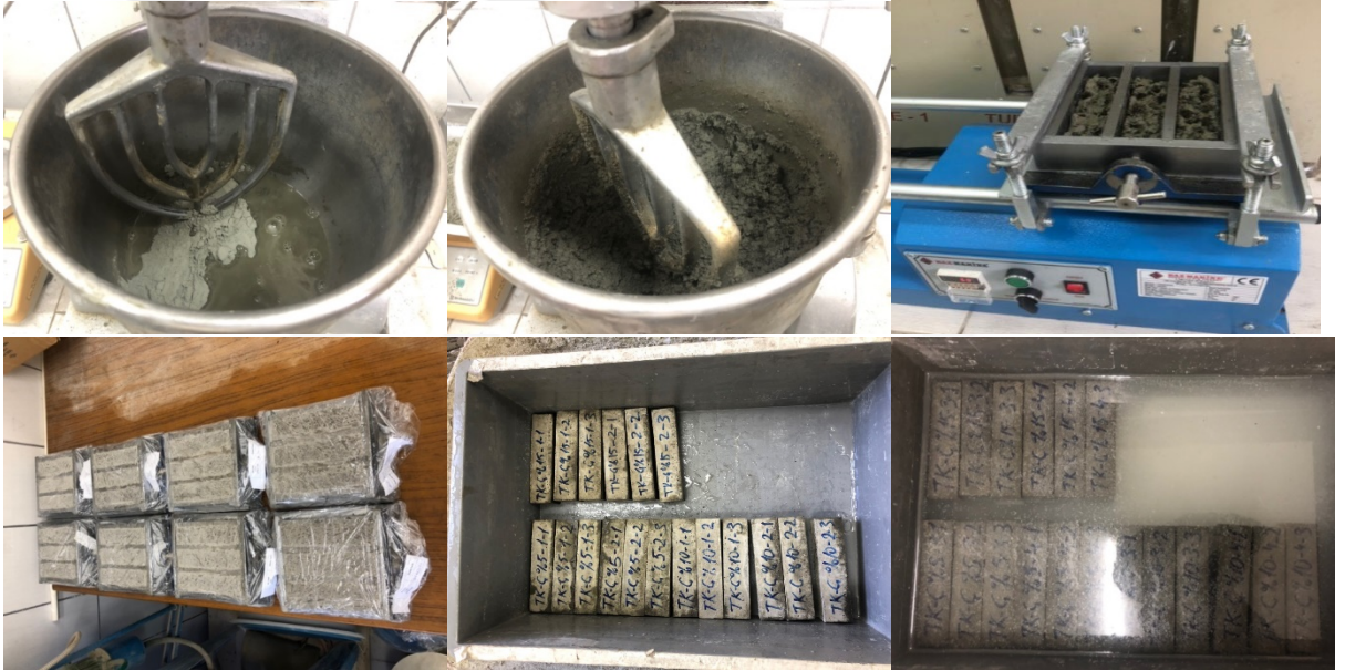
Şekil 3.6. Harç numune üretimi ve numune kürü
