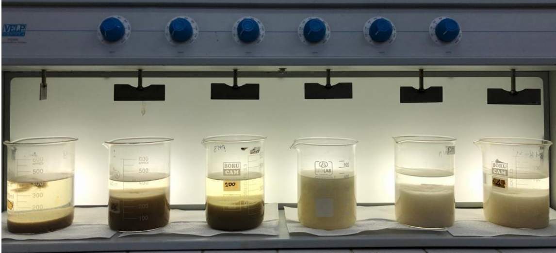
Şekil 3.3. Yağ giderme ünitesi farklı pH'larda sabit alum kullanımı (100 mg/L kons. alum)
