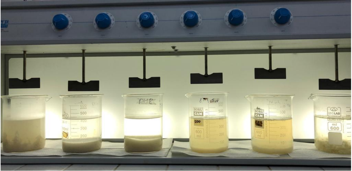
Şekil 3.2. Pikle ünitesi farklı pH'larda sabit alum kullanımı (100 mg/L kons. alum)
