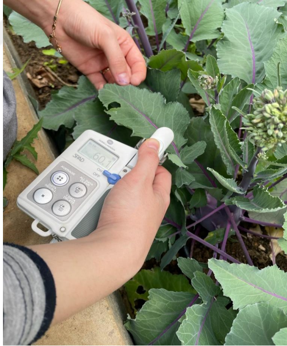
Şekil 2.22. Klorofilmetre ile SPAD değerinin ölçülmesi
