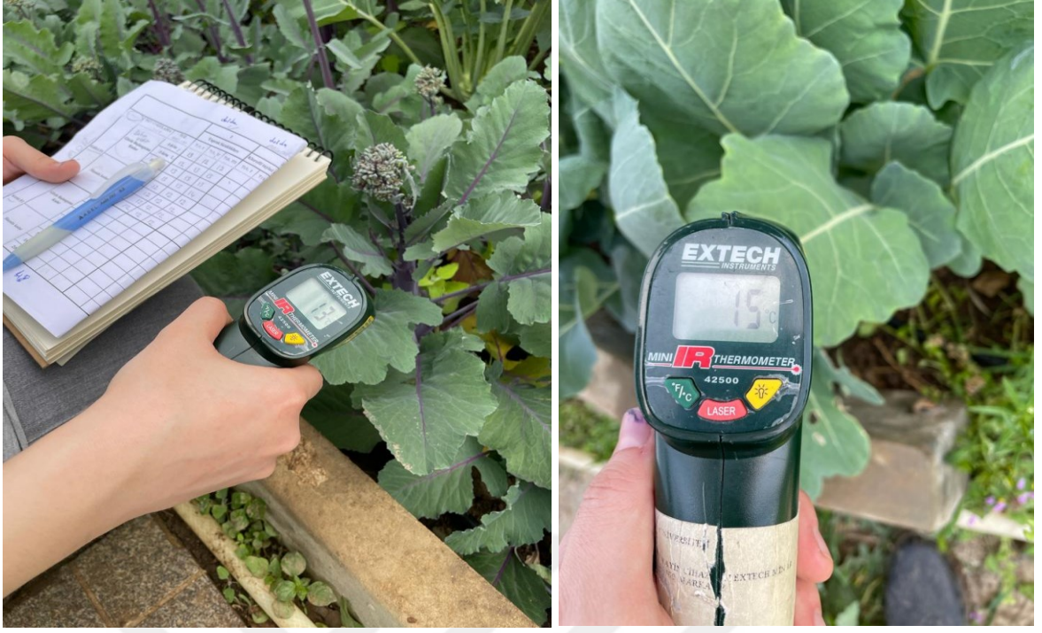
Şekil 2.21. Yaprak sıcaklıklarının infrared termometre ile ölçülmesi
