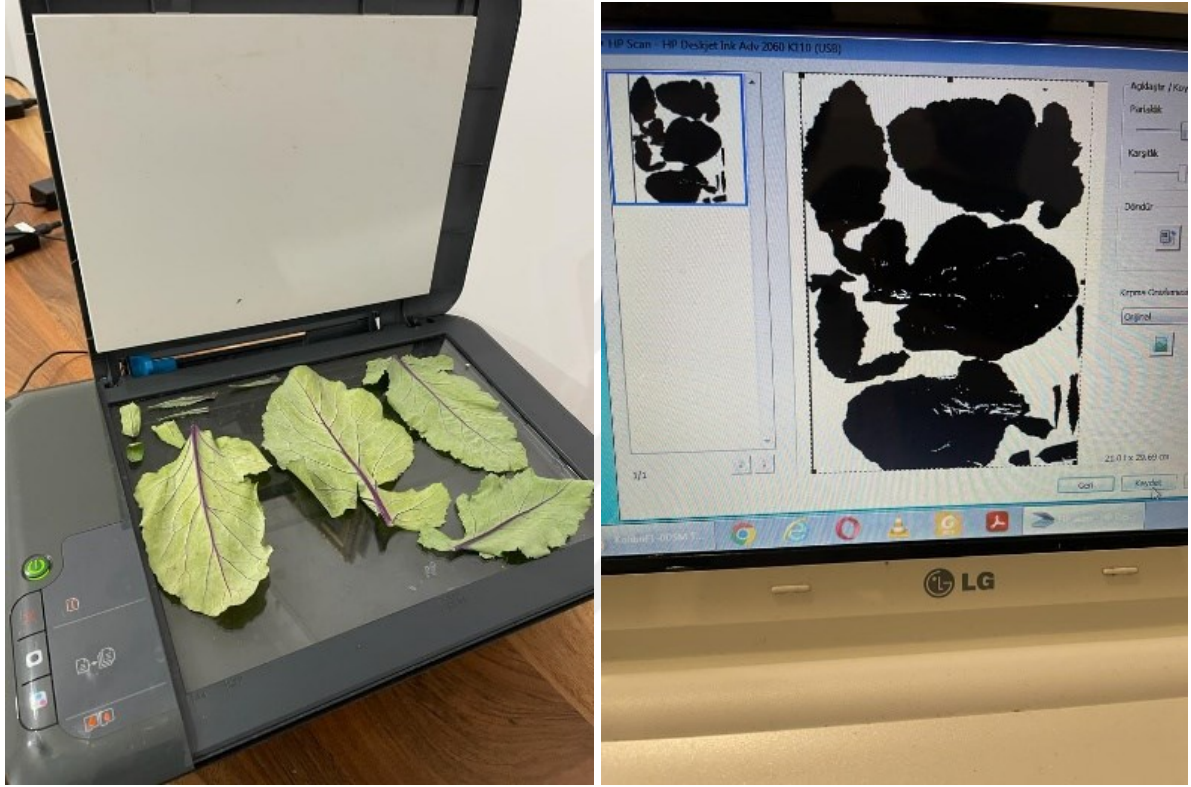
Şekil 2.18. Yaprakların tarayıcıdan geçirilmesi ve bilgisayar programı aracılığı ile alan hesaplarının belirlenmesi
