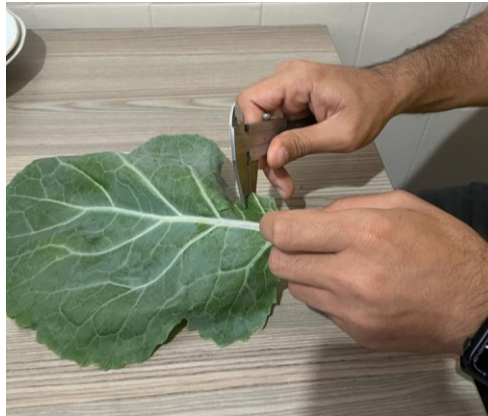
Şekil 2.17. Yaprak kalınlığının kumpas yardımı ile ölçülmesi
