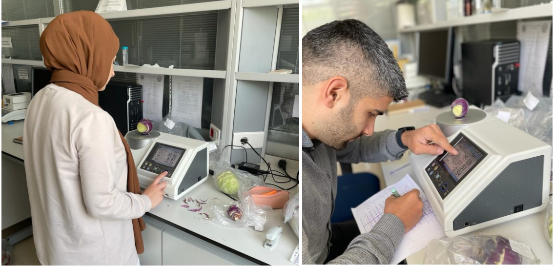
Şekil 2.20. HunterLab D25LT cihazı ile renk değerlerinin ölçülmesi
