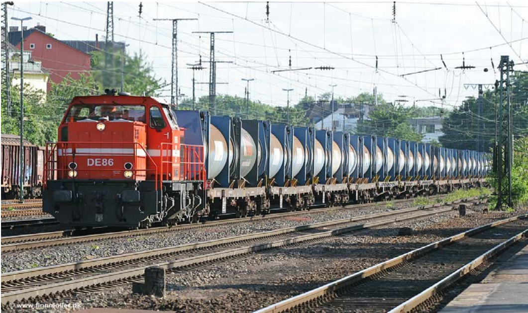
Şekil 3.5. Atıkların direkt olarak vagona yüklenmiş hali (Finnmoller, 2010)
