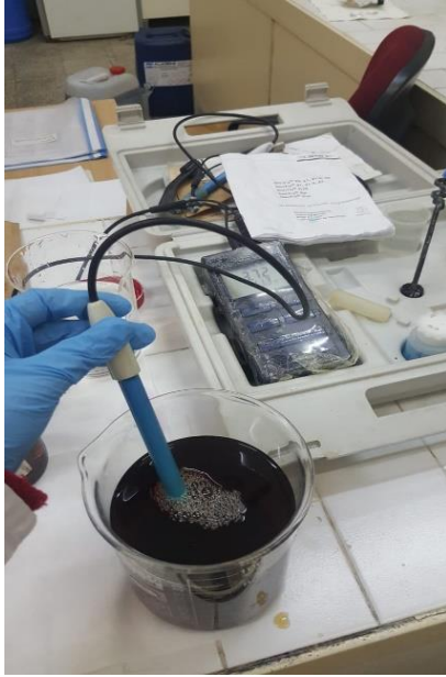
Şekil 3.4. Asitle parçalama pH ayarlama
