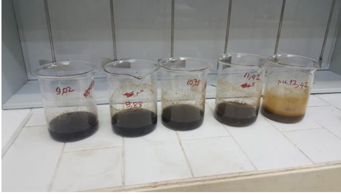
Şekil 3.5. Kireçle çöktürme pH ayarlaması
