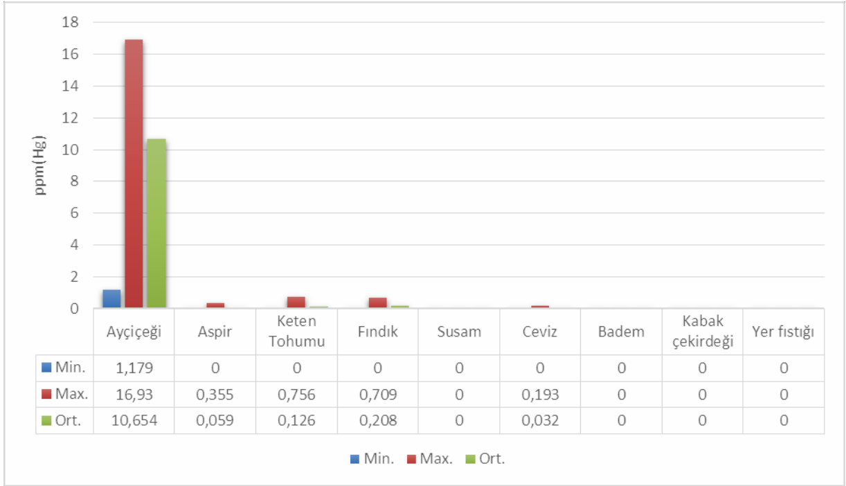
Şekil 4.10. Hg elementi sonuçlarının 9 farklı soğuk pres yağ çeşidindeki değişimi
