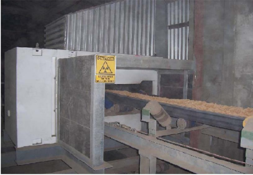
Şekil 2.5. Lastik bant üstü on-line analizör (Anonim 2008)
