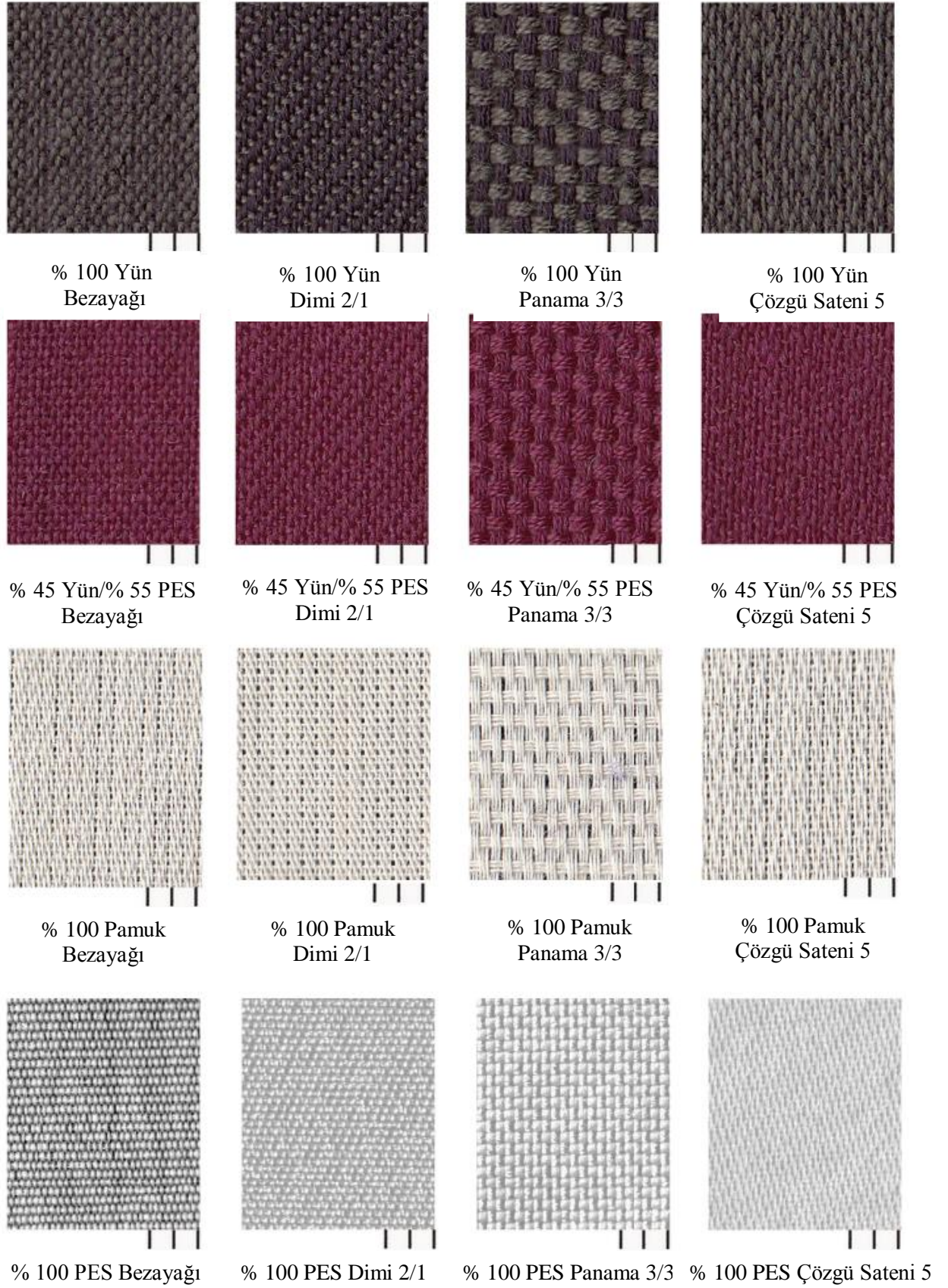
Şekil 3.1. % 100 Pamuklu, % 100 Yünlü, % 45 Yün / % 55 PES ve % 100 PES elyaf içeriğine sahip bezayağı, Dimi 2/1, Panama 3/3 ve Çözü Sateni örgü türlerindeki kumaşlara ait görüntüler (Numuneler çözgü doğrultusunda konumlanmış olup ölçek aralıkları 1 mm'dir)
