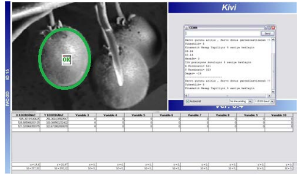
Şekil 5. Kameranın şekli tanınması ve koordinatlarının belirlenmesi.
