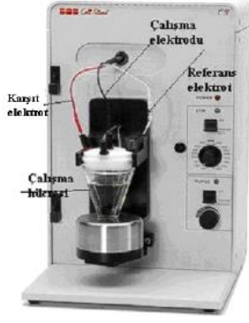
Şekil 3.1. Ölçümlerde kullanılan BAS C3 elektrot hücre standı
