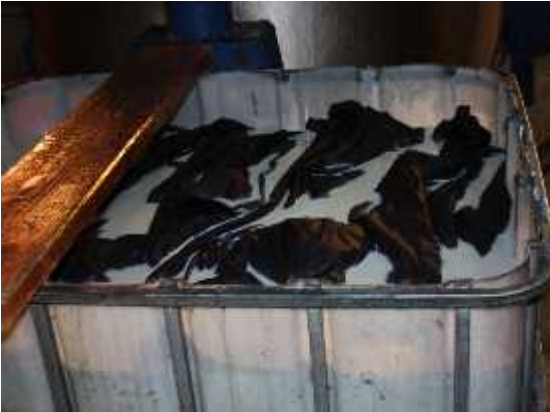
ekil 2.30. Daldırma ile reçine aplikasyonu (Denim Village)
