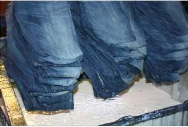
ekil 2.32: Daldırma ile reçine aplikasyonu yapılan ürünlerin süzülürken görünümü (Denim Village)
