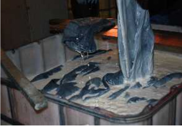
ekil 2.31. Daldırma ile reçine aplikasyonu yapılan ürünün havuzdan çıkarılırkenki görünümü (Denim Village)
