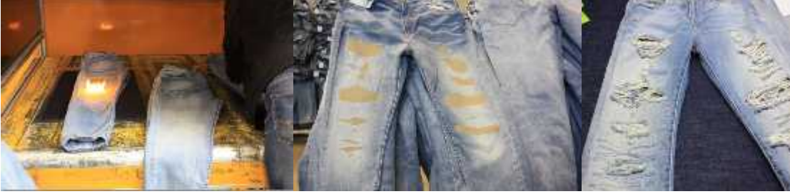
ekil 2.10. Denim ürünlerde lazer iş le mi ve lazerle elde edilen yıpratma görünümü (Denim Village)
