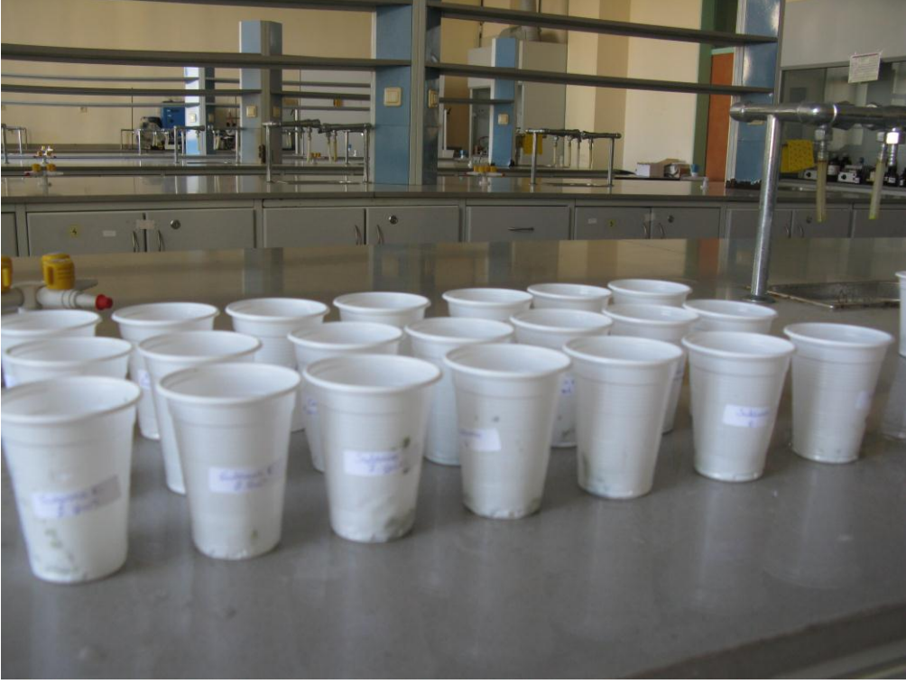
Şekil 3.7 Deşarj Kanalından (IP-1) alınan su numunesinin 100 ml'lik reaktörlerdeki deney öncesi görünümü
