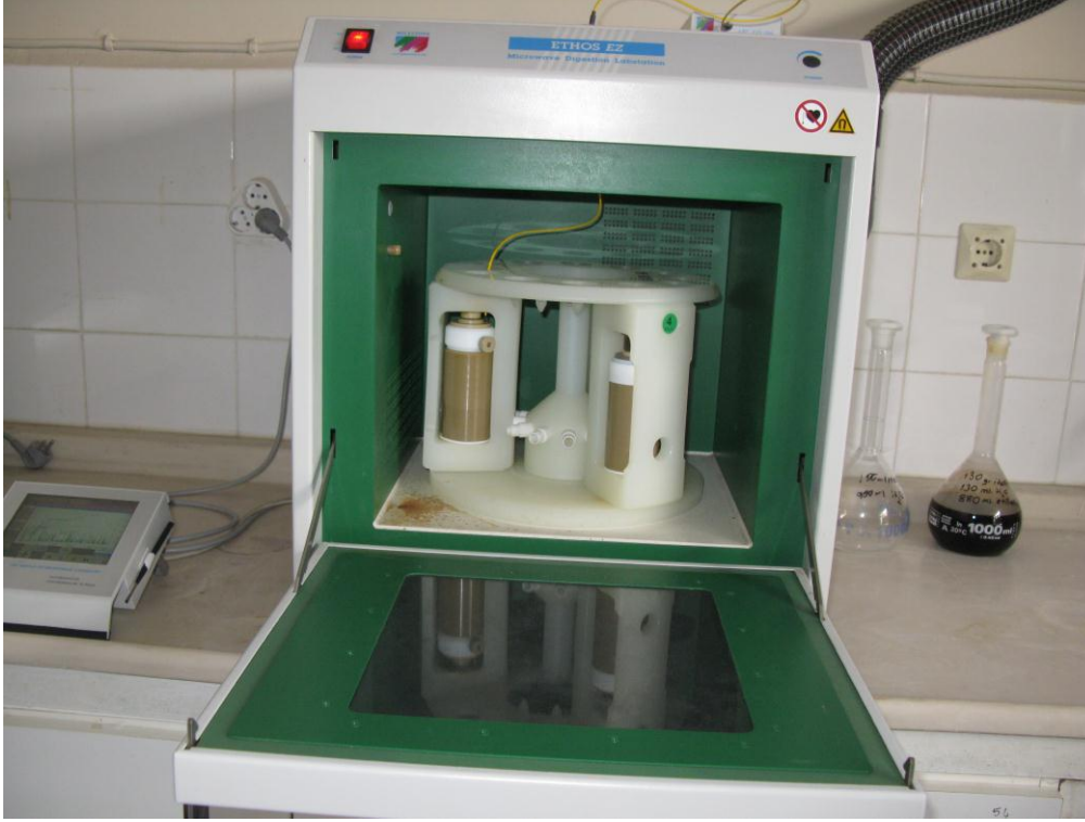
Şekil 4.19 Bitkilerin mikrodalgada yakılma işlemi
