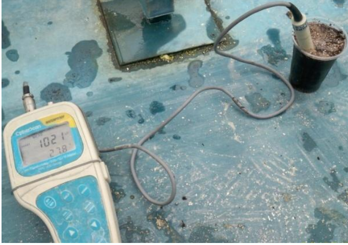
Şekil 3.5. EC metre ile yetiştirme ortamının tuzluluğunun ölçülmesi
