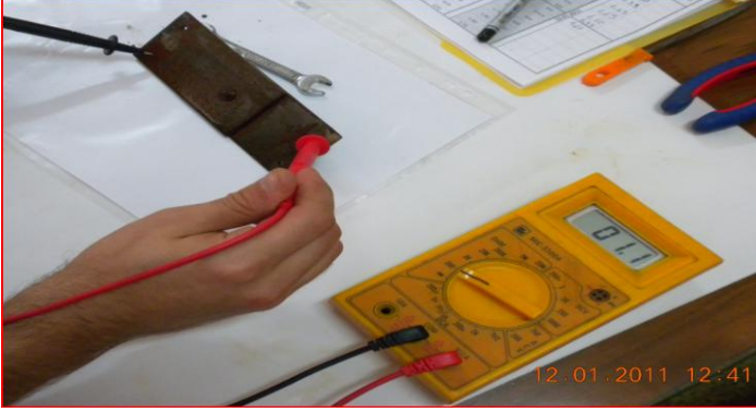
Şekil 3. 6. Direnç ölçümü için kullanılan ohmmetre
