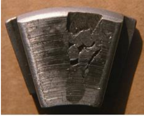
Şekil 2. 24. Korozyon sonucu çatlamış ve malzeme kaybetmiş makine parçası
