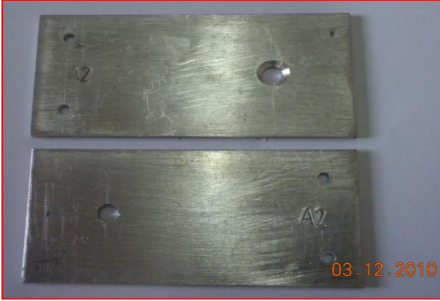
Şekil 3. 2. Alüminyum sac levhadan (Al 99,8) imal edilen birleştirilecek olan parçalar
