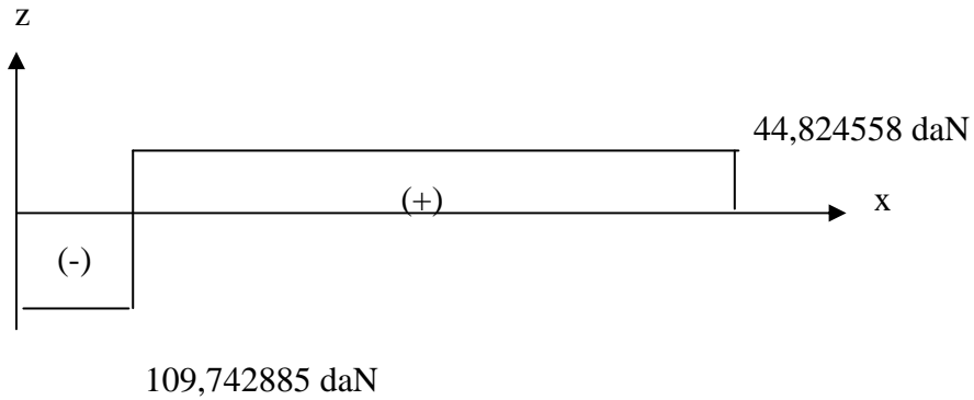
Şekil 4.3. Redüktörün x-z düzlemi birinci mil kuvvet diyagramı
