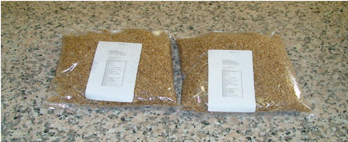
Şekil 3.5. Yığından alınan 1 kg'lık numuneler
