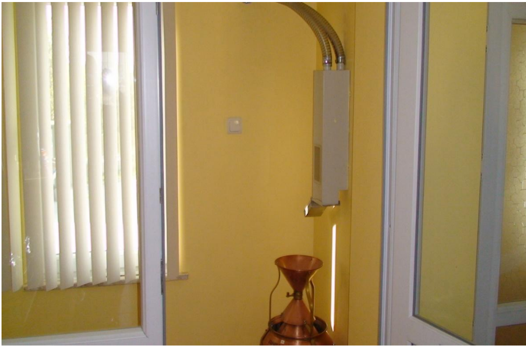
Şekil 3.4. Buğday numune alım düzeneği
