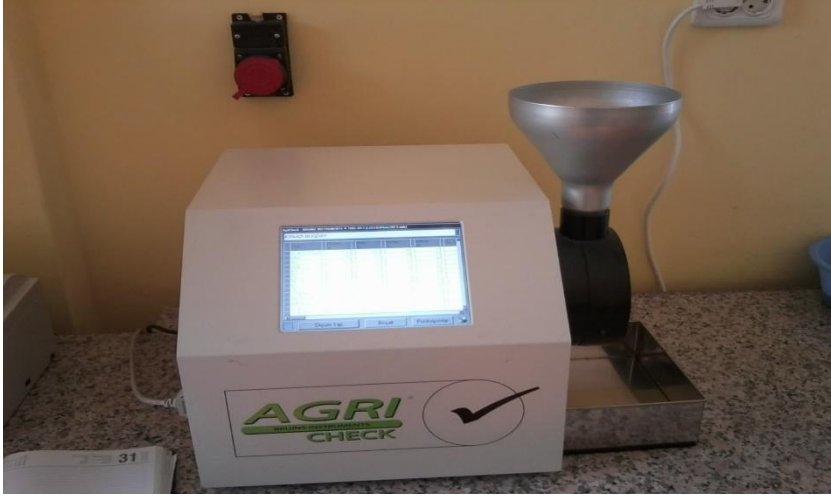
Şekil 3.7. Buğday'ın hektolitreye ölçüm cihazı
