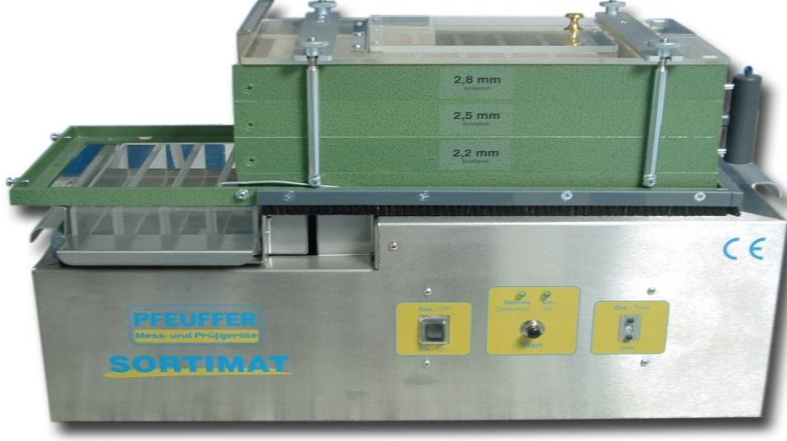
Şekil 3.9. Buğday' da yabancı madde miktarını belirlemeye yarayan SORTİMAT cihazı
