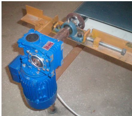
Şekil 3.1.6.1 Tahrik ünitesi fotoğrafı
