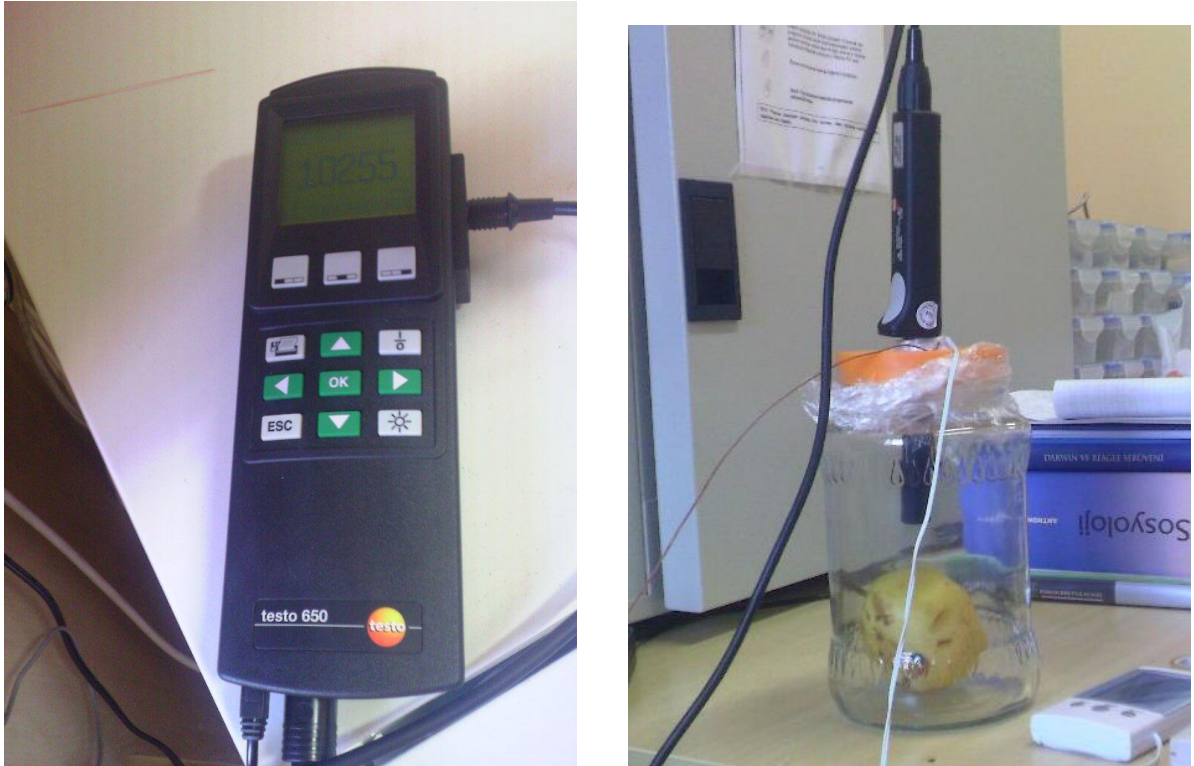
Şekil 3.5. Testo 650 data logger ve CO 2 ölçüm probu
