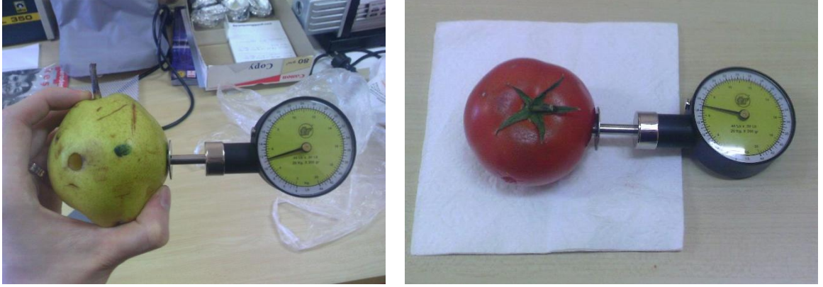
Şekil 3.7. Meyve penetrometresi ile meyve sertliklerinin ölçümü
