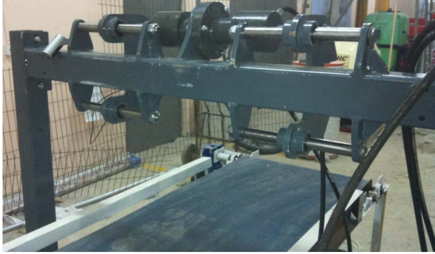
Şekil 4.6. Yataklama ve sabitleme sisteminin laboratuvar düzeneği üzerindeki duruşu
