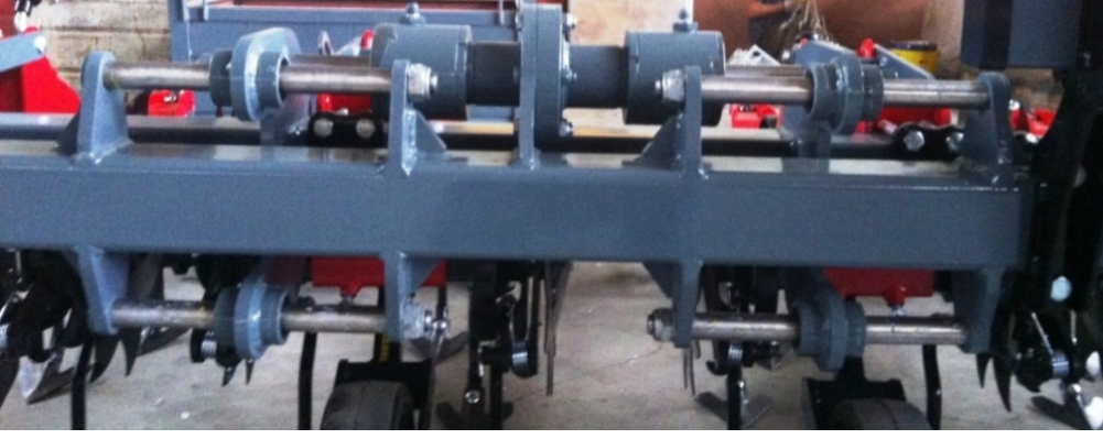
Şekil 4.8. Çift taraflı hidrolik silindirin şase üzerine montaj şekli
