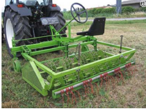
Şekil 1.5. Operatör kontrollü şase kaydırmalı hassas çapa makinesi (AYALA, 2010)
