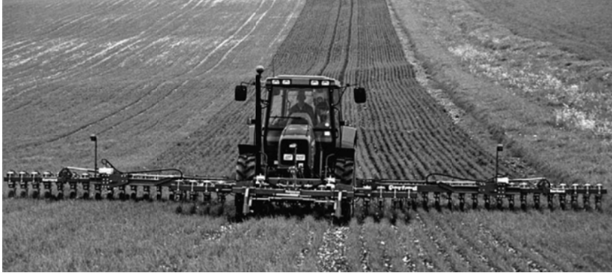
Şekil 2.1. Deneysel birbirinden bağımsız kontrollü üç adet 4mlik üniteden oluşan, görüntü algılayıcı 12m çapalama makinesinin önden görünüşü
