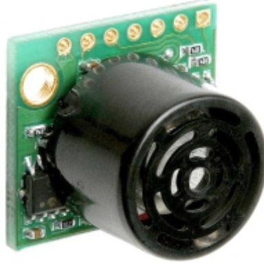
Şekil 3.5. LV- MaxSonar- EZ4 ultrasonik sensör
