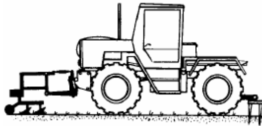
Şekil 1.2. Traktör önüne bağlanan çapalama aleti (PERMEM, 2011)
