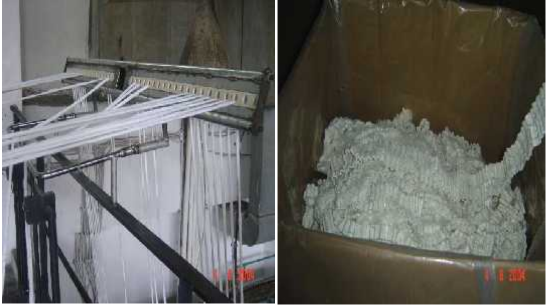
ekil 2.1. PET Ambalaj Atıklarından Elde Edilen Elyaf (Karamangil 2008)
