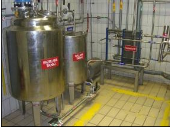
Şekil 3.1. Miks hazırlama tankı, pastörizatör ve homojenizatör
