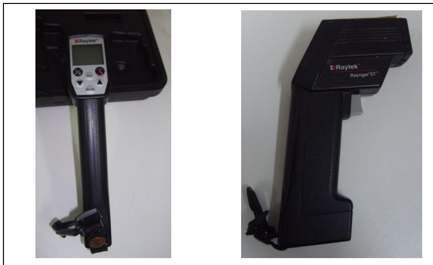
Şekil 3.6. Yaprak yüzey sıcaklıklarının ölçüldüğü İnfrared termometre (Raynger ST8)
