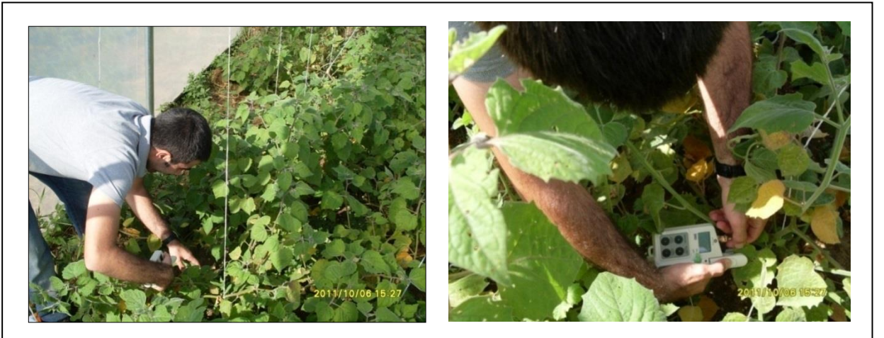
Şekil 3.7. Klorofil ölçüm cihazı ve yerkirazının kuraklık stresi sonrası klorofil ölçümlerine ait görüntüler
