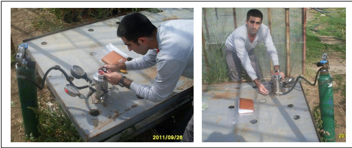
Şekil 3.4. Scholander basınç odası ile gün ortası yaprak su potansiyeli ölçümleri
